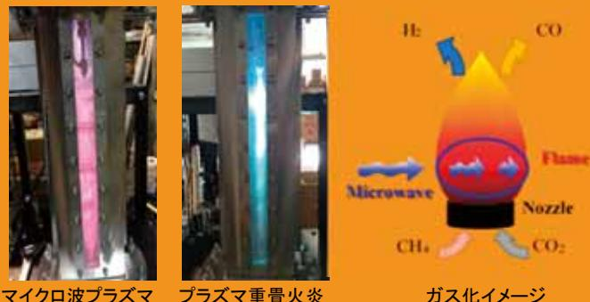
マイクロ波プラズマと燃焼を融合することで活性なラジカルが反応場に生成され、それにより反応が促進される手法です。この特性を利用して、環境汚染物質の分解に関する研究を行っています。その結果、新燃焼法を開発するとともに新しい発電システムを構築できると期待しています。
