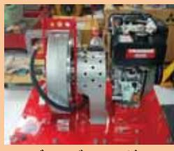
PM2.5は非常に小さいために、従来の装置では高効率捕集が難しいですが、van der Waals力を利用することで、PM2.5の高効率捕集に成功しました。現在はシミュレーションや実際のディーゼルエンジンを用いた実験により実用化を目指しています。
