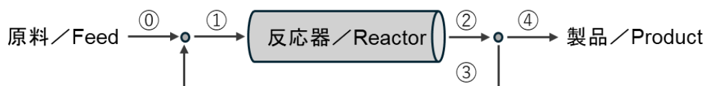
Figure 1. リサイクル流れを有する反応器 / Reactor system with recycle stream
